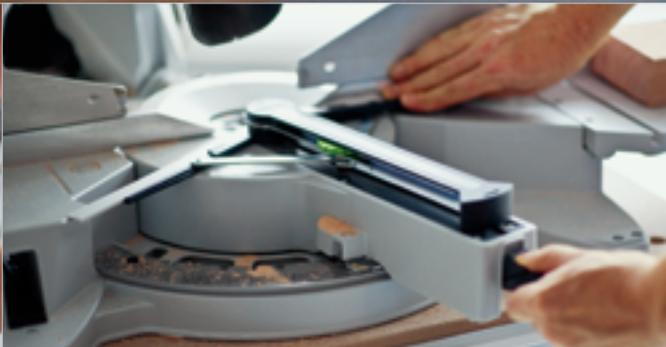
Exakte Sägeschnitterkennung und Winkelübertragung durch Doppellinienlaser und Winkelschmiege der KS 120.
